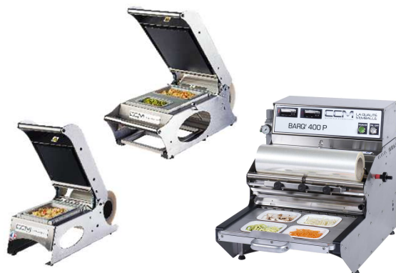
Operculeuses manuelles et semi-automatiques
